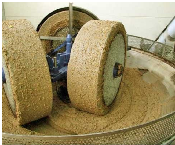
Figure 26: Mullers (by website https://www.elicriso.it/it/olio/estrazione_olio_olive/ )
