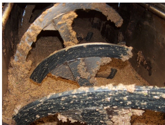
Figure 30: Kneader (by website https://www.elicriso.it/it/olio/estrazione_olio_olive/ )
