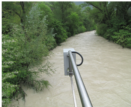
Figura 7.1.: Esempio di sensore idrometrico utilizzato per l'acquisizione automatica delle misure di altezza.
