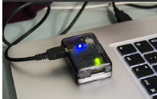
Figura 3.2.: Unità x-IMU utilizzata per le acquisizioni inerziali.
