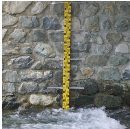
Figura 7.2.: Asta idrometrica utilizzata per la lettura diretta del livello del fiume.
