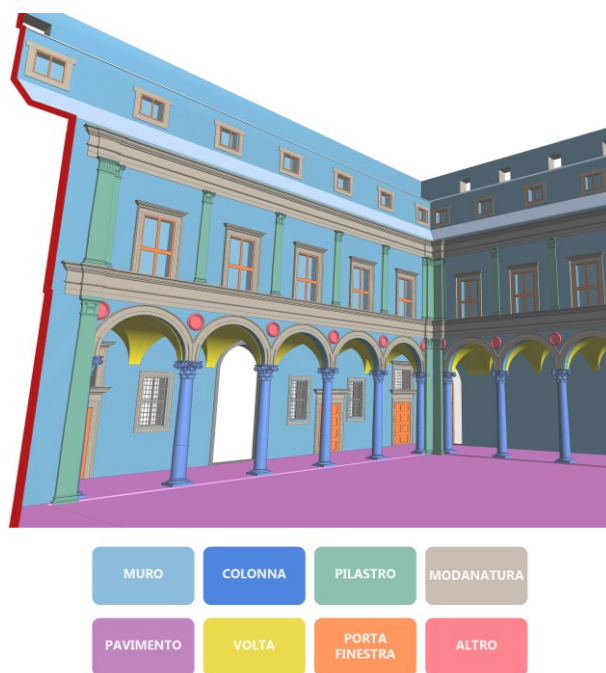
Figura 48. Identificazione delle classi di elementi per il cortile d'Onore del Palazzo Ducale di Urbino, edificio principale su cui si è impostato il lavoro di preparazione del setup sperimentale.
