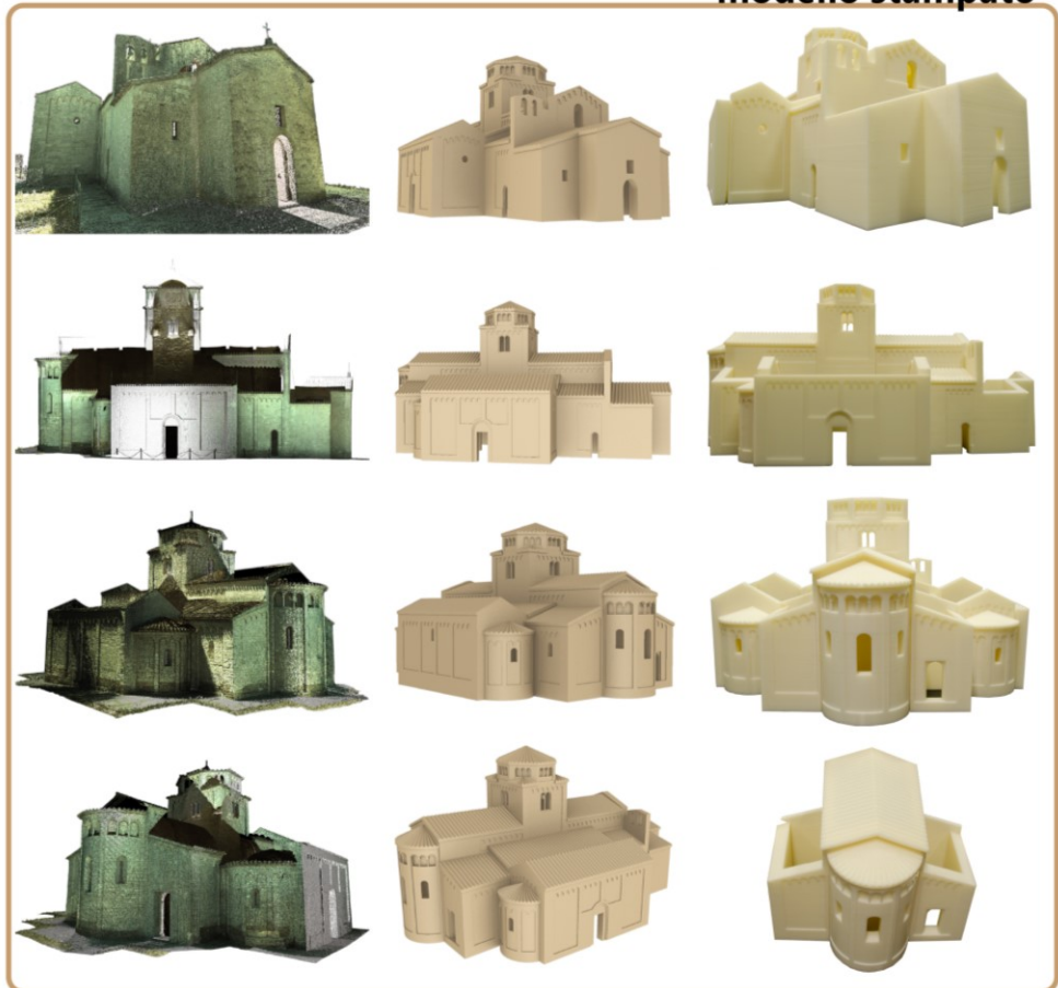
Figura 11. Processo dalla point cloud al modello stampato. A sinistra la Chiesa di Portonovo in ambiente Cyclone, al centro il modello in Revit e a destra il fac-simile stampato.
