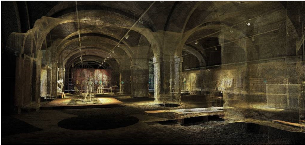
Figura 17. Cyclone, vista della nuvola di punti degli spazi interni della Mole.
