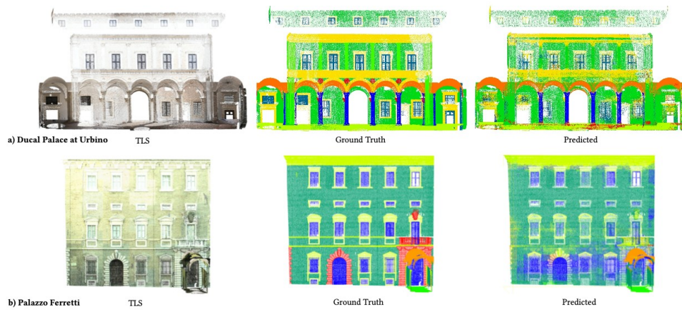
Figura 52. Visualizzazione dei risultati della segmentazione automatica di Palazzo Ducale (a) e Palazzo Ferretti (b).
