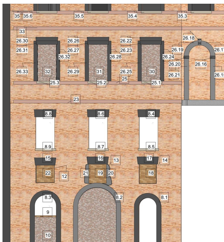
Figura 34. Revit, etichette delle u.s.: ciascuna di esse riporta l'ID/contrassegno univoco.
