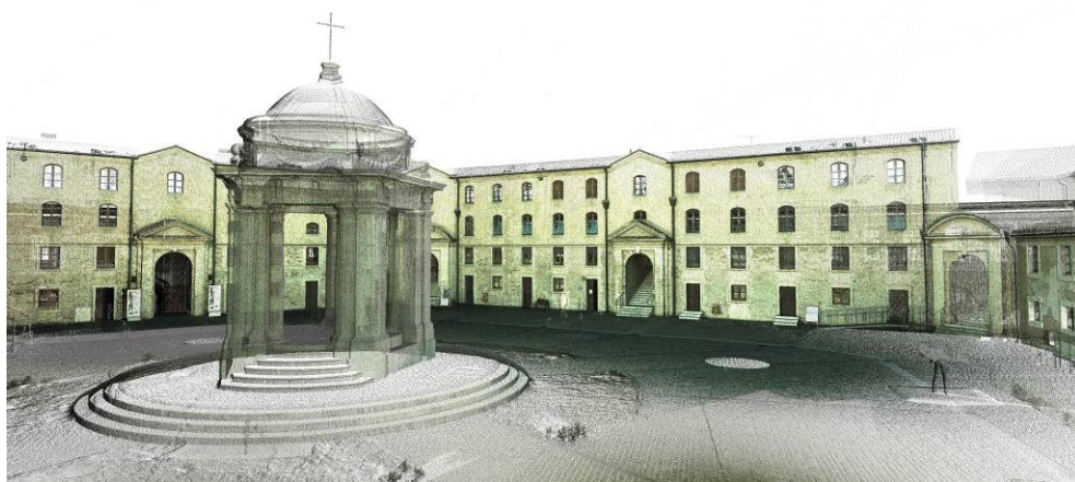
Figura 16. Cyclone , vista della nuvola di punti del cortile interno della Mole e Tempio di San Rocco.
