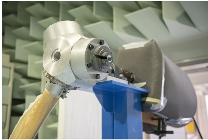
Figura 5.7: Vista della copertura fono-isolante del motore
