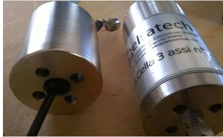
Figura 4.18: Bilancia estensimetrica, sulla destra e manicotto di collegamento con la barra di sostegno, sulla sinistra
