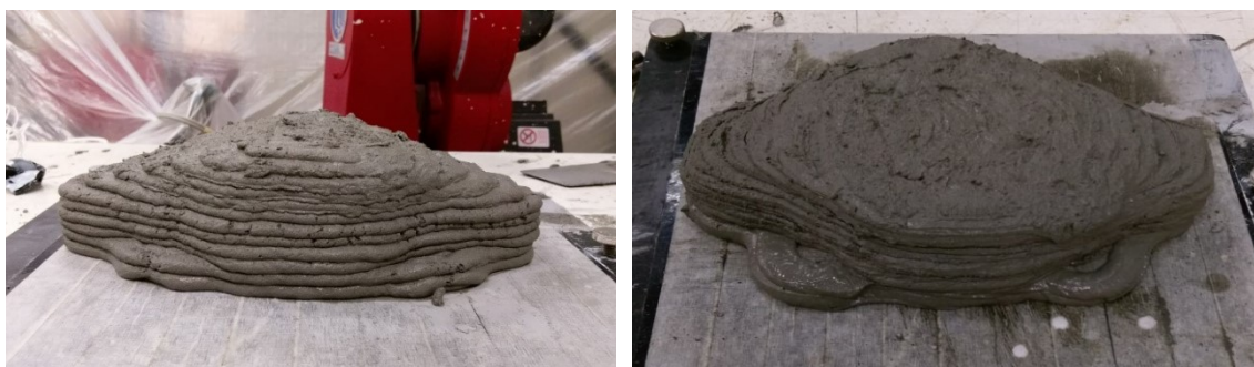
Figura 10.7 - Prototipo di punzone estruso in calcestruzzo
