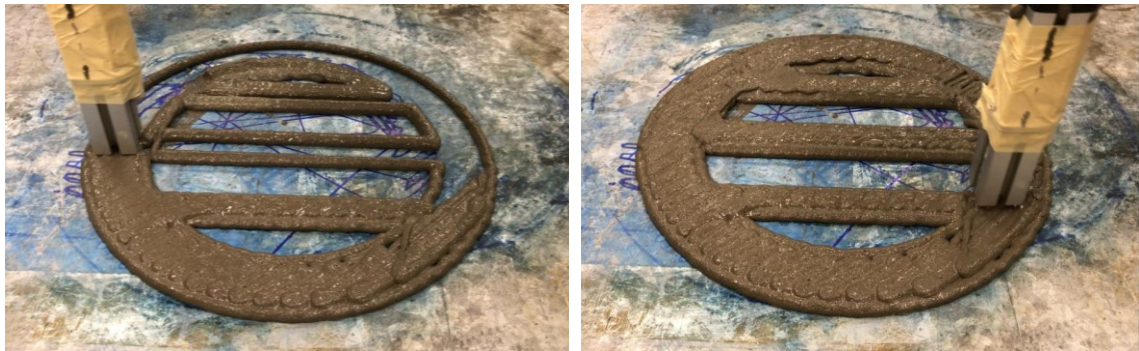
Figura 10.9 - Fasi di estrusione del primo strato del prototipo
