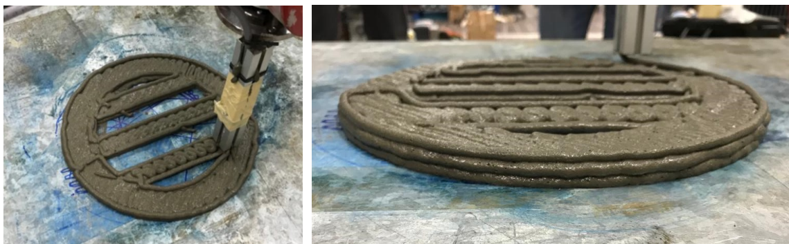
Figura 10.10 - Fasi di estrusione del terzo strato del prototipo
