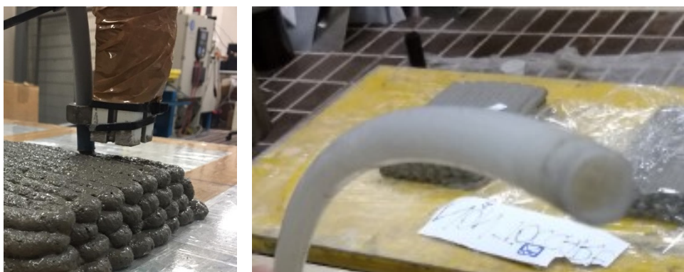
Figura 3.8 - Dettaglio dell'ugello di estrusione
