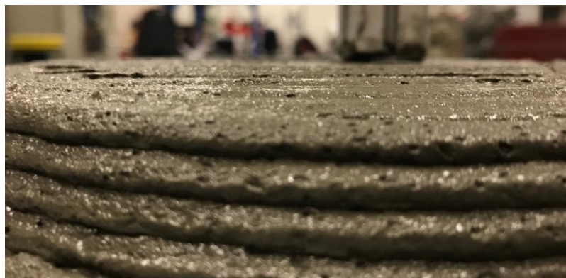
Figura 10.13 – Particolare della finitura superficiale (print quality)
