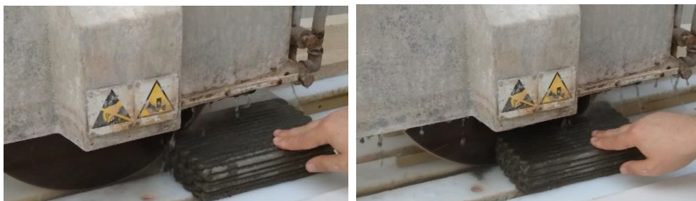
Figura 9.7 - Taglio dei prototipi tramite sega circolare
