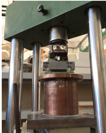
Figura 3.12 - Esecuzione della prova di flessione su 3 punti
