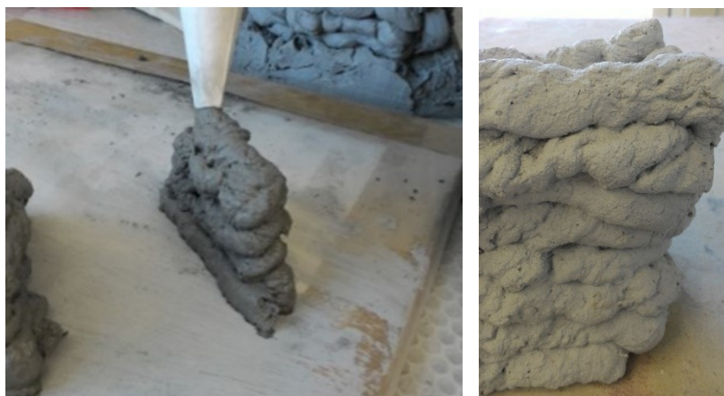
Figura 5.4 - Prova di estrusione della miscela NO CEM
