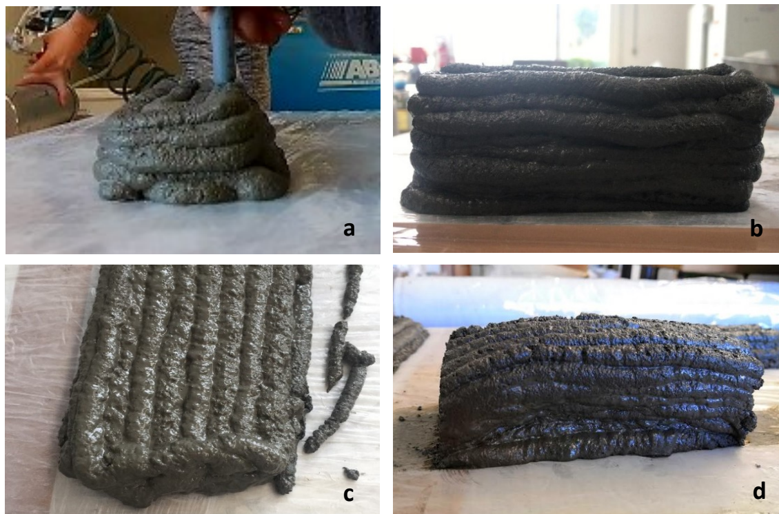
Figura 9.1 - Prova di estrusione delle miscele: (a) SAND50-PWD50; (b) PWD100; (c) PWD50-GRAN50; (d) PWD25-GRAN75
