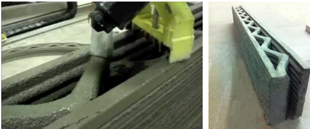
Figura 1.7 - Sezione di muro estruso con la tecnica del Contour Crafting
