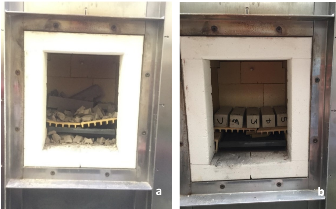
Figura 8.2 - Provini “Refr+FS” (a) e “Refr-Mod”(b) a fine ciclo termico
