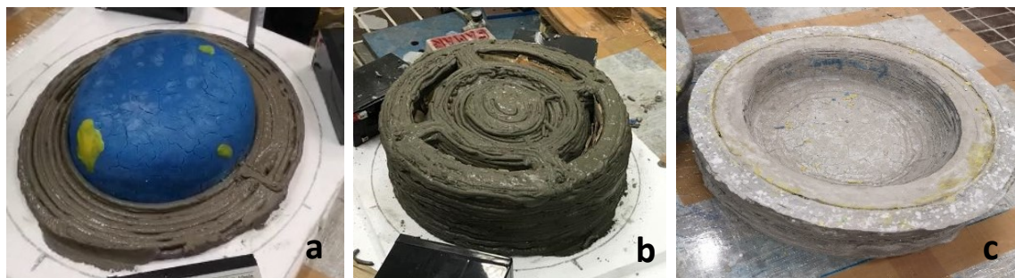
Figura 10.15 – Prototipo matrice: (a) fasi di stampa; prototipo matrice vista esterna (b) e vista interna (c)
