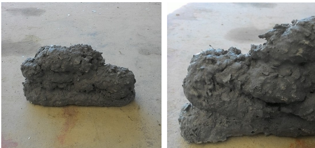
Figura 5.2 - Prova di estrusione della miscela PET
