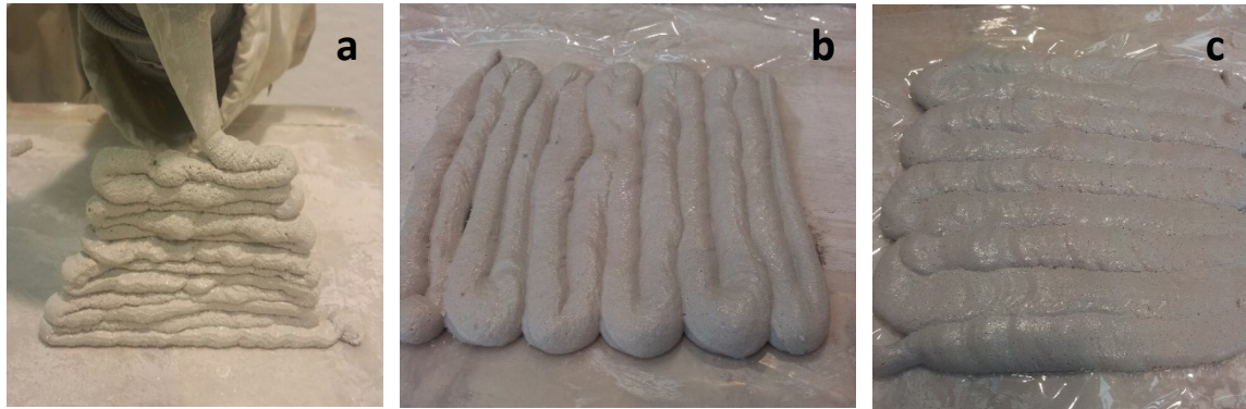
Figura 4.4 – Prove di estrudibilità della miscela SRA+CaO-FS: (a) ottima shape stability; (b) buona conformità dimensionale; (c) ottima print quality.
