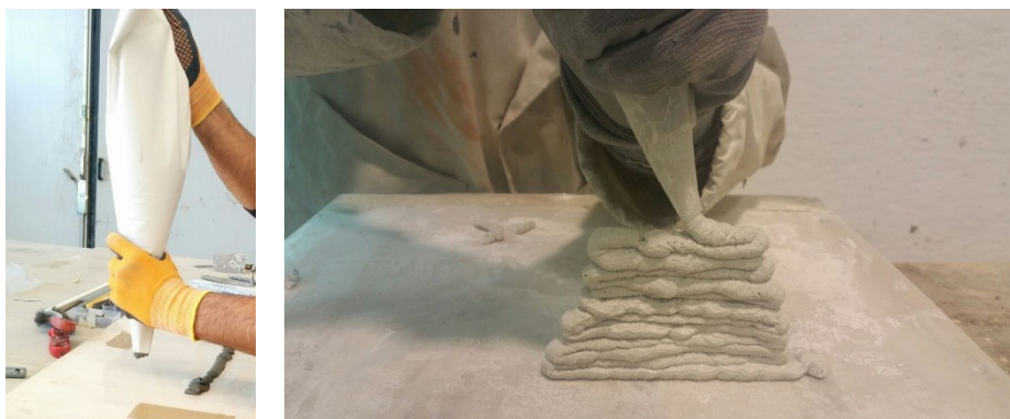
Figura 3.2 - Esempio di estrusione tramite sac à poche
