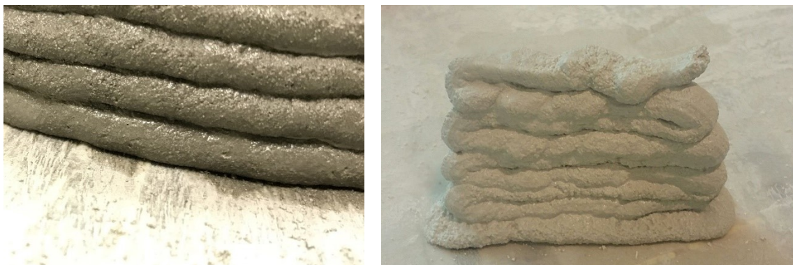
Figura 3.17 - Shape stability test effettuati in laboratorio: esempi di buona shape stability
