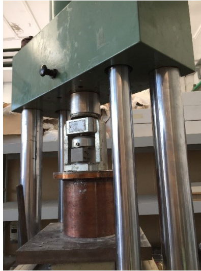
Figura 3.14 - Esecuzione di una prova di resistenza a compressione
