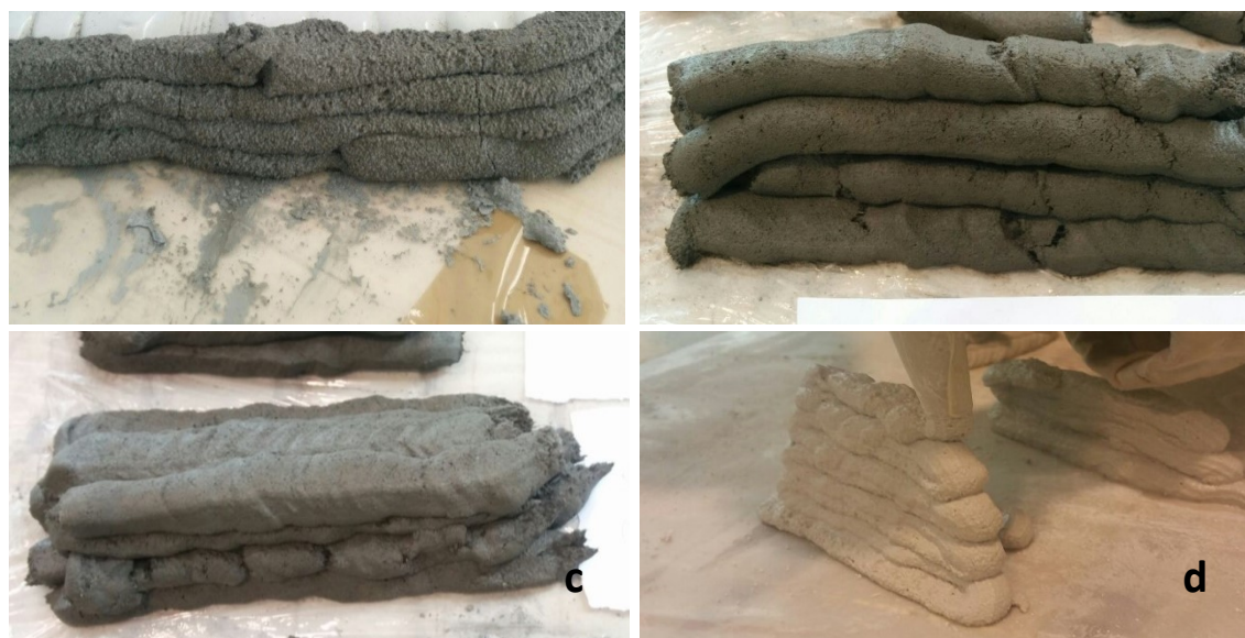
Figura 4.1 – Prove di estrusione: (a) RIF; (b) SRA; (c) SRA+CaO; (d) SRA+CaO-FS
