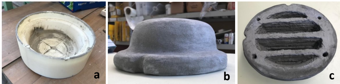
Figura 10.14 - (a) Controstampo; Prototipo di punzone: (b) esterno, (c) interno
