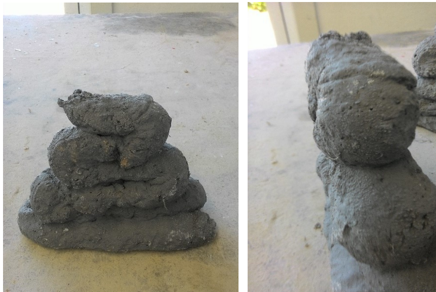
Figura 5.3 - Prova di estrusione della miscela PET+VTR
