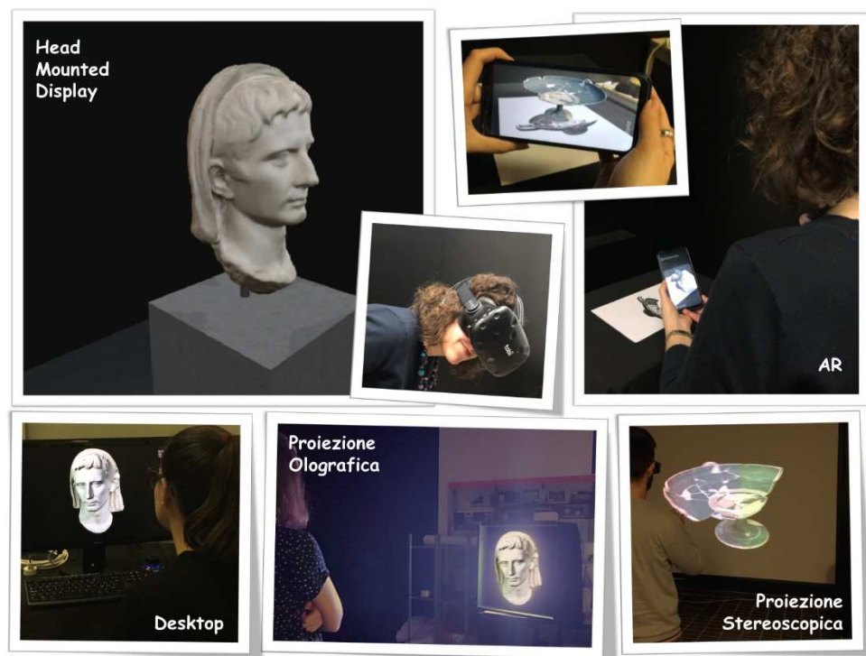
Figura 46 - Le Applicazioni VM Considerate nello Studio: (a) Head Mounted Display; (b) AR mobile; (c) Desktop 2D; (d) Proiezione Olografica; (e) Stereoscopia Attiva;
