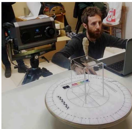
Figura 39 - Acquisizione con Laser Scanner
