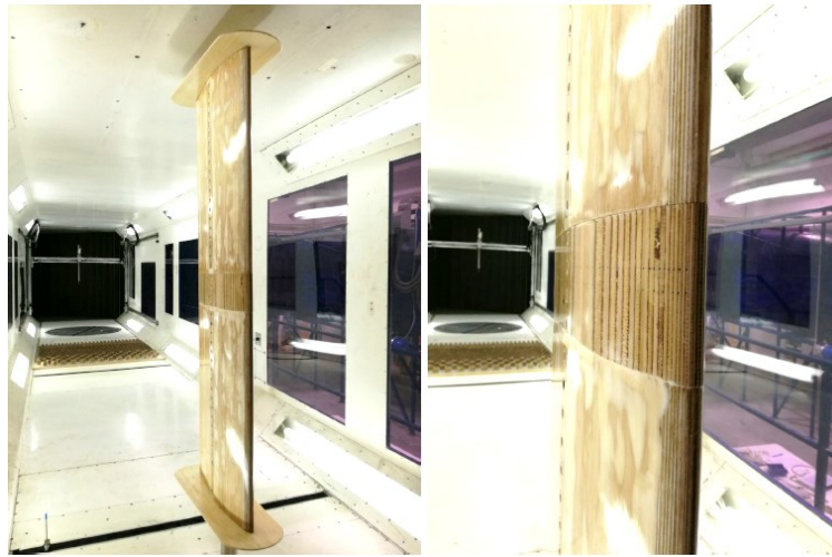
Figura 3.2-8: Posizionamento del profilo nella galleria del vento ambientale
