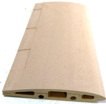
Figura 4.3-14: Modello 3D del profilo alare HQ2512mod. realizzato in legno MDF
