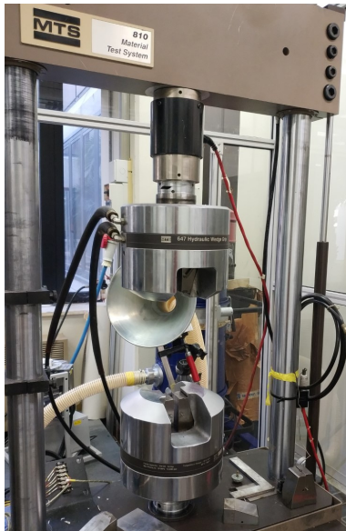
Figura 4.10: Macchina MTS per prove di trazione.
