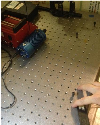
Figura 7.6: Banco prova: il dispositivo cilindrico è la sorgente luminosa nella banda della luce visibile. La parte di fibra ottica con il reticolo di bragg è stata incollata sul provino in composito, fissando in alcune parti del banco prova la restante parte.
