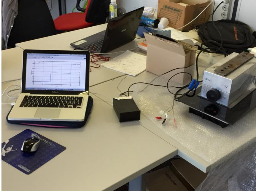
Figura 4.6: Acquisizione in tempo reale dei consumi di potenza misurati mediante pinza amperometrica (in blu) collegata a scheda di acquisizione dati (scatola nera) collegata a PC, quando il piano ad induzione scalda lo stampo.
