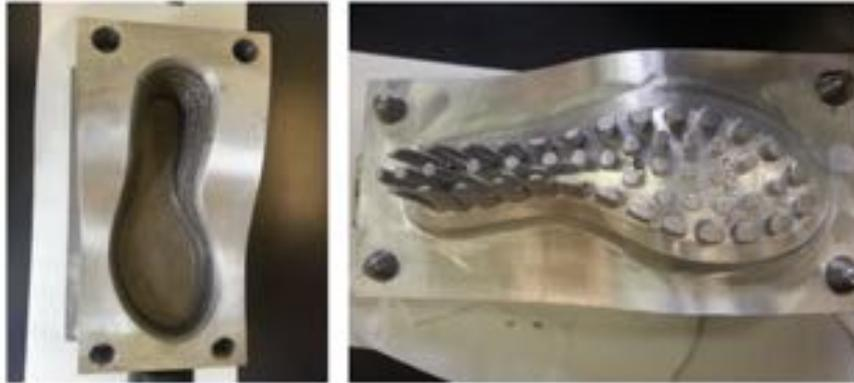
Figura 5.8: Stampo per soles in acciaio-alluminio.
