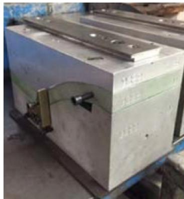
Figura 5.6: Stampo in Acciaio-Alluminio.
