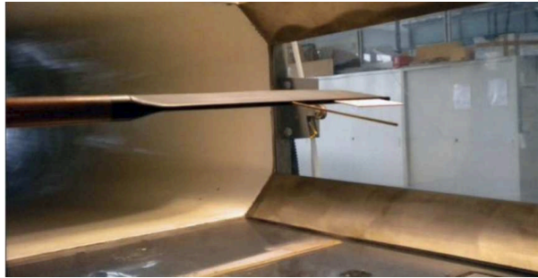
Figura 5.7: Wake-rake per la misura di velocità in scia
