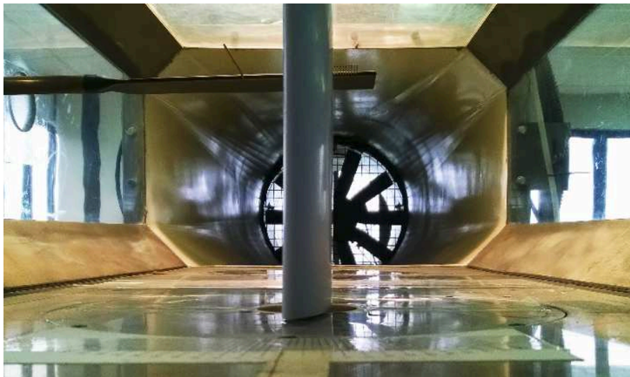
Figura 5.8: Profilo 3D in galleria del vento
