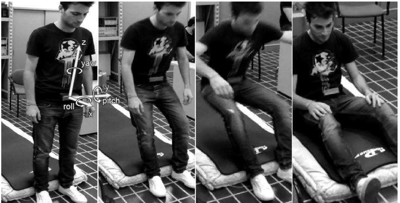
Figura 6.7: Esempio di svolgimento di una prova di caduta sopra un materasso
