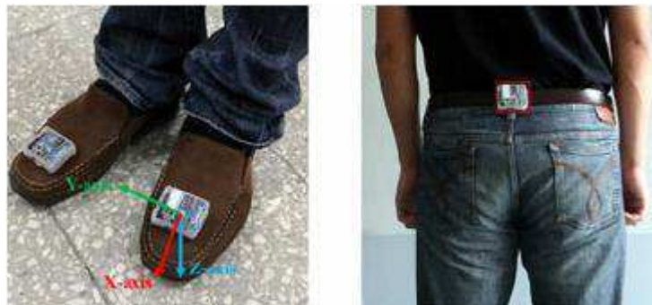
Figura 2.5: Piattaforma inerziale per l'analisi della camminata
