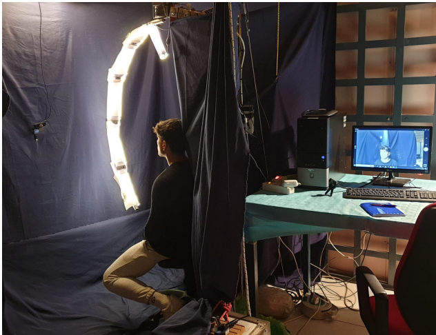
Figura 5.1: MCMPprototype, composto da un braccio motorizzato su cui è installato un sistema d'illuminazione dissipata a led e 4 fotocamere, posizionate ad angolature zenitali di +60^\circ , +30^\circ , 0^\circ e -30^\circ , gestite da Raspberry Pi Zero W.
