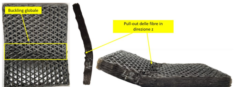
Figura 6.36: Esempio di buckling globale della struttura isogrid al 42% ID
