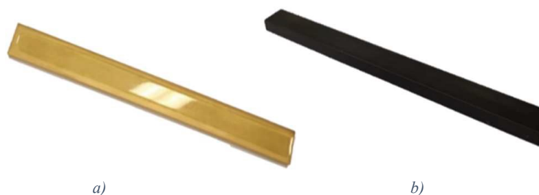
Figura 5.1: Provini realizzati in resina pura (a) e in resina rinforzata con GO (b)
