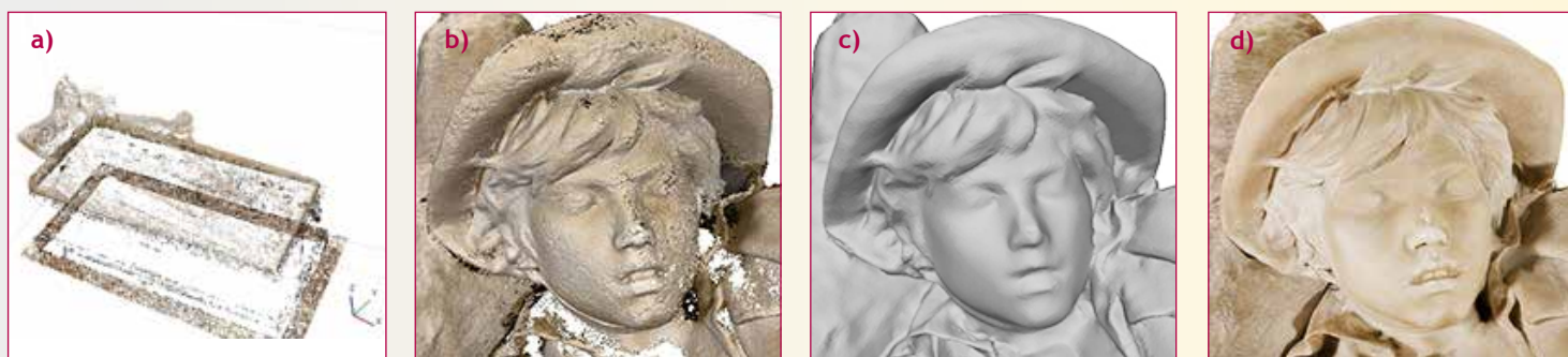
Fig. 5 - Processo SfM per il "Riposo del Pastorello": a) Punti di riferimento generati per l'intero modello, b) Nuvola di punti densa della testa del pastorello, c) Modello 3D senza texture, d) Modello 3D complesso finale con la texture.
