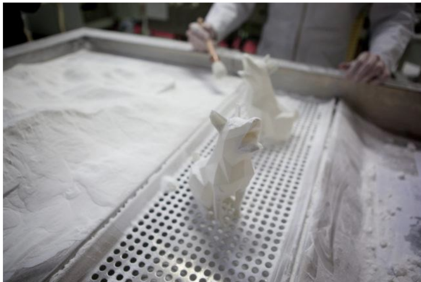
Figura 18: Esempio di componenti realizzati per sinterizzazione a letto di polvere utilizzando un materiale polimerico.
