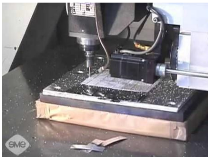
Figura 13: Esempio di lavorazione per Ultrasonic Additive Manufacturing.
