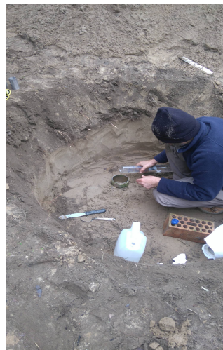
a) b) Figura 4-5. a) Schema realizzativo della prova INF in pozzetto superficiale; b) fase operativa entro apposita trincea in campo prova.
