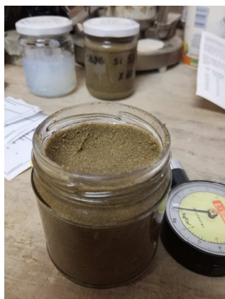
Figura 8-5 - (a-b) ricostituzione dei campioni in contenitori di vetro per l'esecuzione di prove con pocket penetrometro su sabbia trattata e gel puro.
