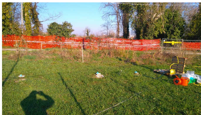
Figura 4-20. a) Schema campo prova per test di diluizione; b) disposizione delle attrezzature di pompaggio e sensori per il controllo in tempo reale.
