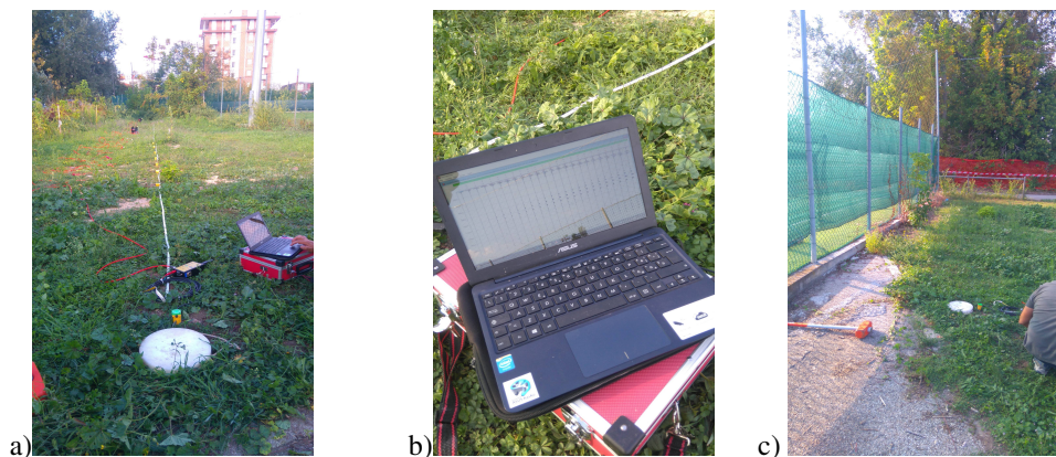
Figura 5-11. (a) Schema geometrico esecutivo della prova; b) acquisizione ed elaborazione dati; c) martello e piastra di energizzazione.
