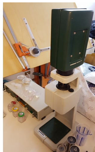
Figura 6-16. Viscosimetri rotazionali utilizzati nell'ambito dei test; (a) Mod. Brookfield RVV 6.3; (b) Rheomat 115 .
