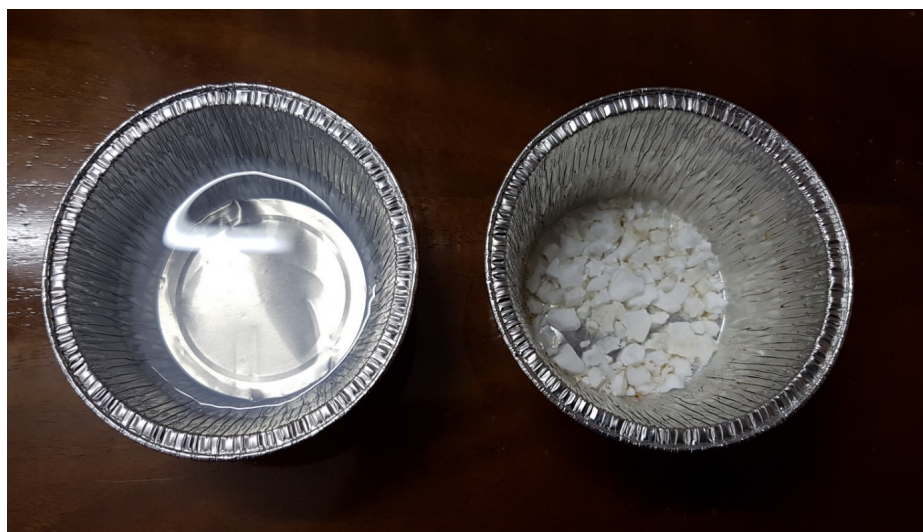
Figura 6-31. Essiccamento a 200° di campione di miscela D a concentrazione CS 7.5% e contenuto salino 0.1 N .
